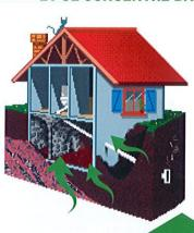
Le gaz radon peut s'infiltrer dans un bâtiment à travers chaque défaut d'étanchéité (percement, trou, fissure, vide autour des canalisations et gaines techniques, etc...) situé entre le sol et le bâtiment. Il risque ensuite de s'y accumuler si le renouvellement d'air dans le bâtiment est insuffisant, par exemple lorsque le système de ventilation est défectueux.
