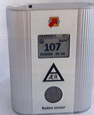
Exemple de moniteur numérique de détection du radon en temps réel.
